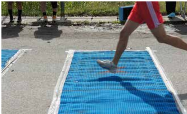
チップを装着したシューズで計測用マットを通過するとタイムが自動計測されます
